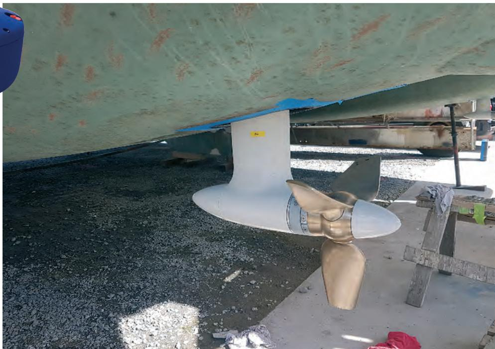
AXC también puede instalarse como sistema doble en catamaranes y barcos a motor. El AXC ofrece muchas de las mismas ventajas que los sistemas de propulsión a vela SD y de propulsión por eje AX de Oceanvolt, sólo que ahora con una mayor autonomía de crucero, una mayor velocidad máxima e incluso menores niveles de vibración y ruido a bordo gracias a la propulsión directa. Los sistemas AXC también requieren mucho menos espacio a bordo en comparación con un motor diésel tradicional.
